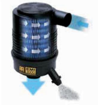
Os filtros de ar EMI-3000 oferecem maior eficiência na filtragem do ar para equipamentos Thermo King através do processo de ação ciclônica de dois estágios. 75% das partículas são removidas do filtro para a válvula de evacuação antes mesmo de atingir o meio filtrante. Isto permite que apenas o filtro da Thermo King atinja a máxima eficiência de 99,97%.
